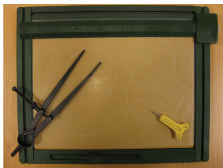
8.sz. kép. Adaptált vonalzók, szögmérők és szerkesztéshez használható eszközök (Forrás: Pajor Emese)
